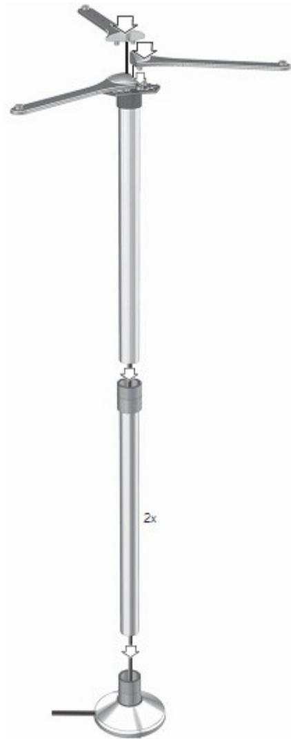
**i** При переносе настроечного микрофона держать за основание, а не за трубку.
