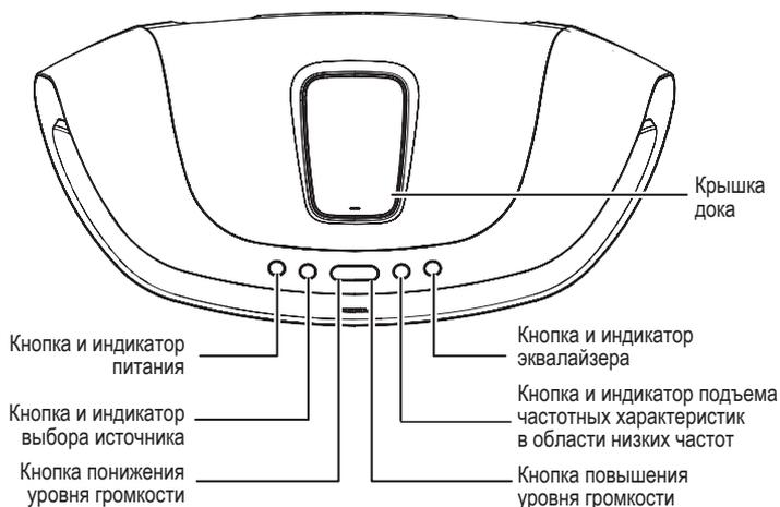
**Кнопка и индикатор подъема частотных характеристик в области низких частот:** нажмите эту кнопку, чтобы улучшить воспроизведение басовых частот. Индикатор будет гореть, когда режим подъема басовых частот включен.
