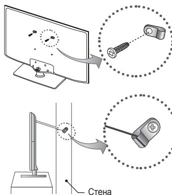
1. Вставьте винты в зажимы и надежно закрепите их на стене. Убедитесь, что винты надежно закреплены в стене.
