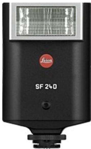
В режимах M и TTL диапазон рабочих светочувствительностей простирается от 12 до 3600 ISO, а в режиме A - от 25 до 800 ISO. Угол излучения соответствует углу зрения объектива с фокусным расстоянием 35 мм. С помощью двух дополнительных диффузоров его можно изменить: для съемки широкоугольным объективом 24 мм и телеобъективом 85 мм. Вспышка питается от двух литиевых элементов (тип 123, 3В), которые обеспечивают быструю перезарядку и большое число импульсов даже при низких температурах.
