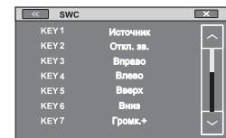
**Пресса [ОТКЛ. ЗВ.] на вашем направляющем колесе в течение 1 секунды.**
