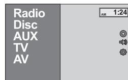
Выбор источника сигнала с помощью сенсорной панели
