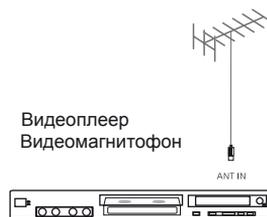
Подключите антенну к видеомagniфону (ANT IN). Подсоедините антенный кабель к антенному разъему телевизора (RF IN) и видеомagniфона (ANT OUT).
