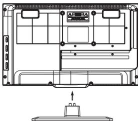
Зафиксируйте с помощью винтов крепления из комплекта поставки.
