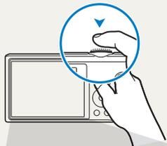
Слегка нажмите кнопку затвора и отрегулируйте фокусировку. При этом камера автоматически сфокусируется на объекте и настроит параметры экспозиции.
