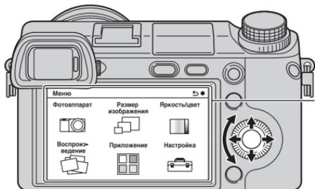
При отображении опций на экране вы можете перемещаться по ним, поворачивая или нажимая на верхнюю/нижнюю/правую/левую части колесика управления. Для выбора нажмите на центр колесика.
