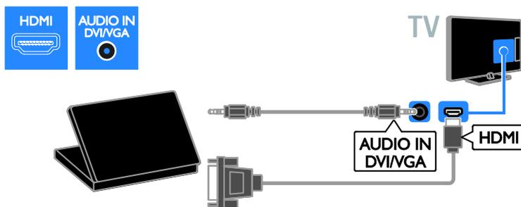
Подключите компьютер к телевизору с помощью кабеля VGA и аудиокабеля.
