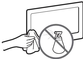
Не распыляйте воду непосредственно на устройство. Попавшая внутрь устройства жидкость может стать причиной повреждения, возгорания или поражения электрическим током.
