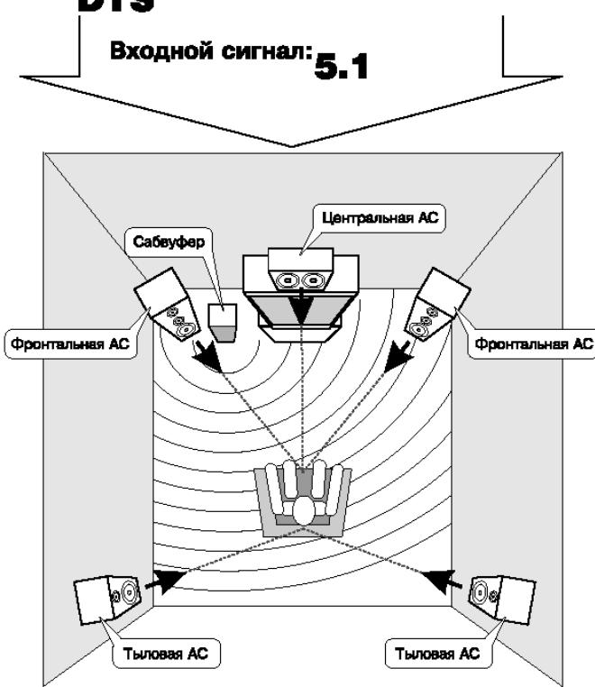
дисков должен быть подключен внешний 6-канальный (5.1) декодер системы DTS Digital Surround или усилитель с встроенным декодером системы DTS Digital Surround.
