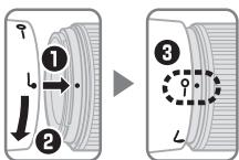
Выровняйте метку закрепления блонды (—○) с меткой крепления блонды (●) на объективе (3).
