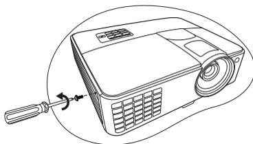
3. Снимите крышку лампы с проектора.
