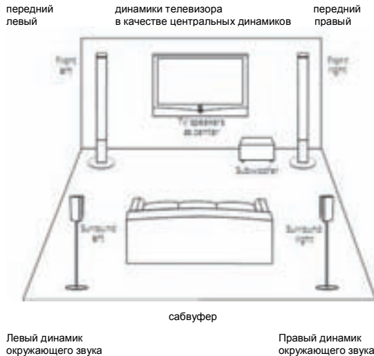
Подключение аудиосистемы Loewe (сабвуфер) к телевизору
