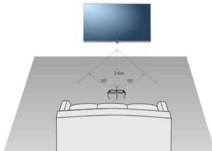
При просмотре 3D-контента 3D-очки получают инфракрасный сигнал от телевизора Loewe 3D TV. ИК-датчик расположен по центру впереди 3D-очков. По этой причине для надлежащего функционирования 3D-очков необходимо их применять при просмотре 3D-телевизора.
