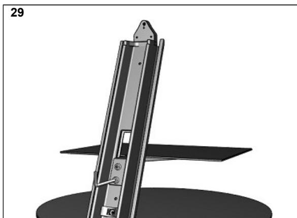
Затянуть винты с помощью ключа, входящего в комплект поставки.
