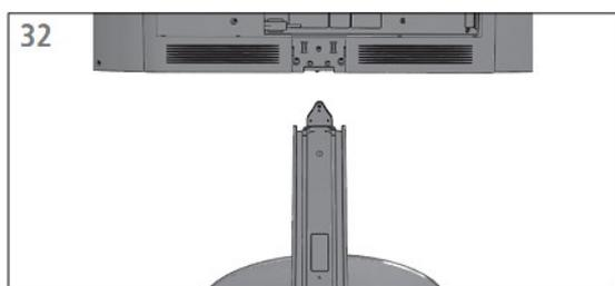
Для снятия телевизора с кронштейна напольной подставки Floor Stand A 32-46 обратиться за помощью к напарнику. Установить телевизор на мягкое, надёжное основание.
