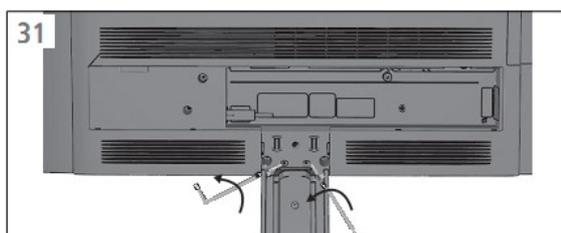
Снять телевизор с напольной подставки Floor Stand A 32-46. Для этого отпустить два винта на задней части телевизора, см.рис. 31.
