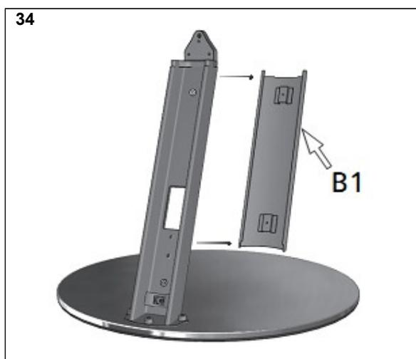
Снять переднюю крышку без отверстия с напольного основания Floor Stand A 32-46 (рис.34, B1).
