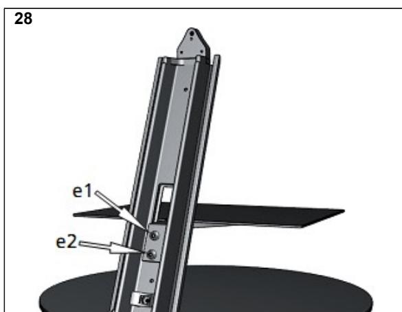
Провести винты с шайбами через отверстия в крючке панели для оборудования. Ушки контактных дисков должны быть направлены к верхней части.
