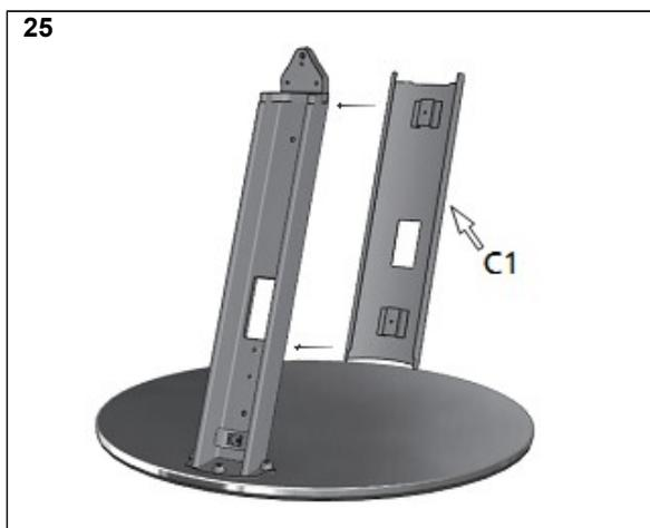
Снять мягкую ткань с упаковочного материала и накрыть ею пластину основания. Мягкая ткань служит для защиты пластины основания от возможных повреждений во время сборки. Взять панель для нижней части кронштейна и закрепить её к кронштейну как показано на рисунках на этой странице. При установке панели следить за тем, чтобы не повредить (не поцарапать) пластину основания.
