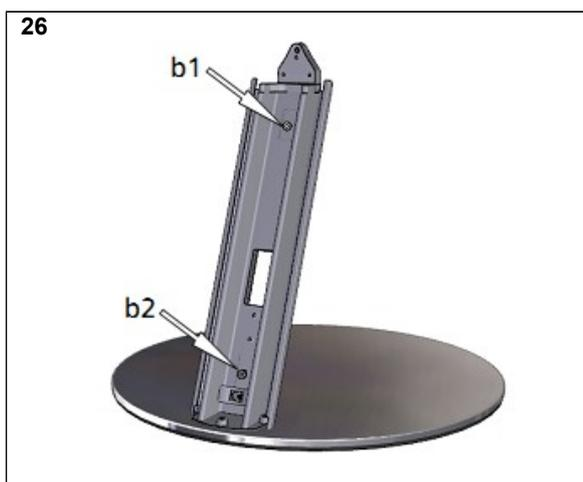
Для крепления использовать два винта, входящих в комплект поставки (рис. 26, стрелка b1, b2). Использовать контактные диски для первоначального удерживания винтов. Ушки контактных дисков должны быть направлены к верхней части. Затянуть оба винта с помощью ключа, входящего в комплект поставки, момент затяжки должен составлять около 2 Нм (слегка).
