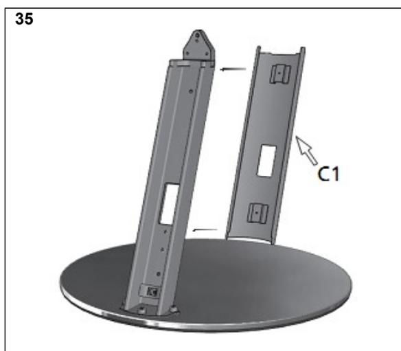
Установить на место крышку с отверстием, входящую в комплект поставки (рис. 35, C1).
