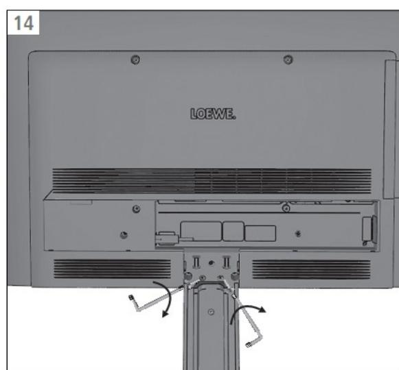
Использовать для крепления винты, ранее снятые с настольной подставки.
