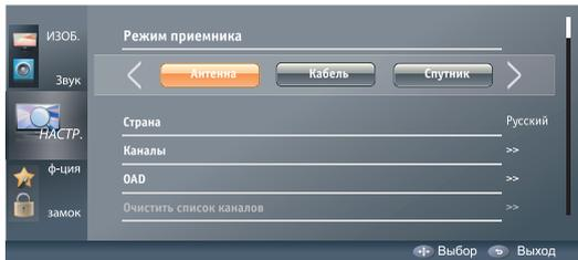
3. Нажмите кнопку  $\blacktriangledown\blacktriangle$ , чтобы задать параметры Режим приемника (Антенна) и Страна. Нажмите кнопку  $\blacktriangleleft\blacktriangleright$ , чтобы выбрать нужное.
