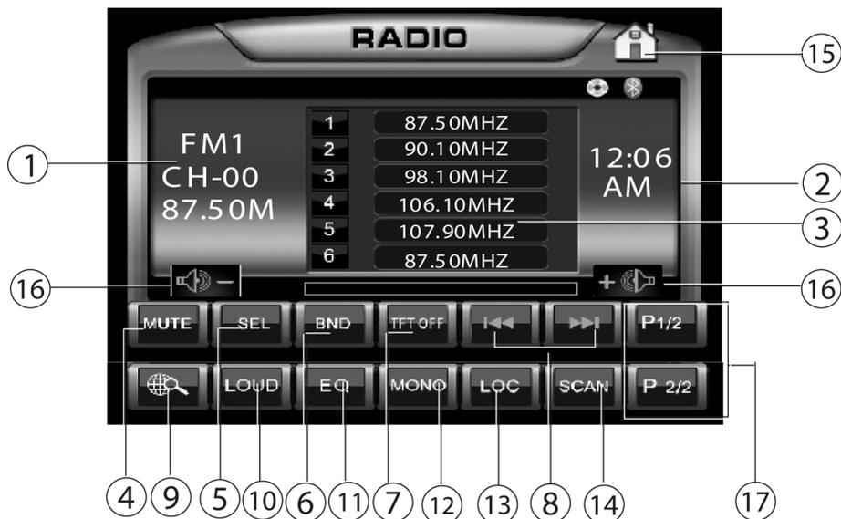
1. Текущий диапазон/номер радиостанции (если она сохранена в память устройства)/текущая частота
