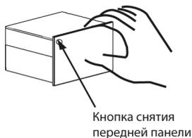
Перед тем как снять переднюю панель, выключите питание прибора. Затем нажмите кнопку снятия передней панели и снимите переднюю панель.
