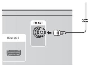
1. Подключите прилагаемую FM-антенну к разъему FM-антенны.
