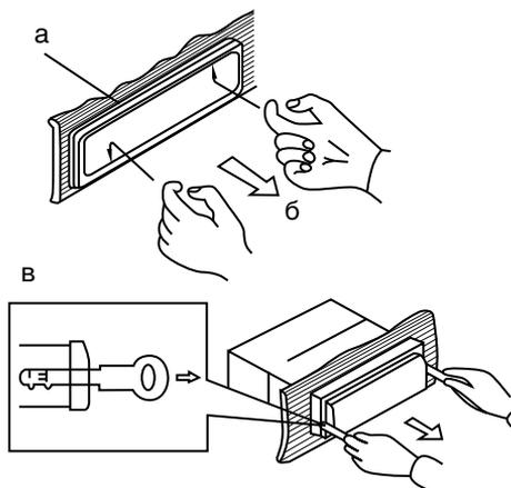
1. Выключите магнитолу и снимите переднюю панель.
