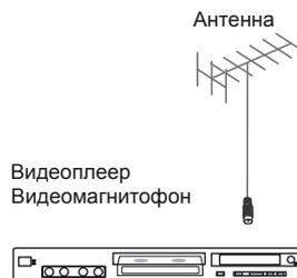
Используйте один из вариантов: Подключите антенну к видеомэгнитофону (ANT IN). Подсоедините антенный кабель к антенному разъему телевизора (RF IN) и видеомэгнитофона (ANT OUT).
