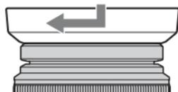
Установите бленду на крепление на конце корпуса объектива и поверните бленду по часовой стрелке до щелчка.
