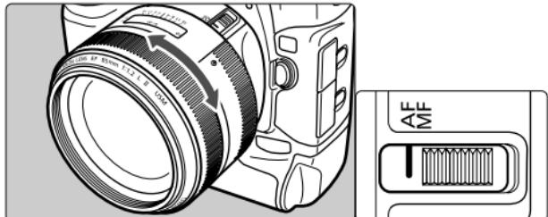
Для съемки в режиме автоматической фокусировки (AF) установите переключатель режимов фокусировки в положение AF. Чтобы использовать ручную фокусировку (MF), установите переключатель режимов фокусировки в положение MF и настройте фокусировку, поворачивая фокусировочное кольцо.
