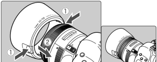
Бленда ES-79 II не допускает нежелательные блики и свет на линзы объектива, а также защищает объектив от попадания на поверхность линзы дождя, снега и пыли. Надевайте бленду на объектив, следуя нижеприведенной процедуре.
