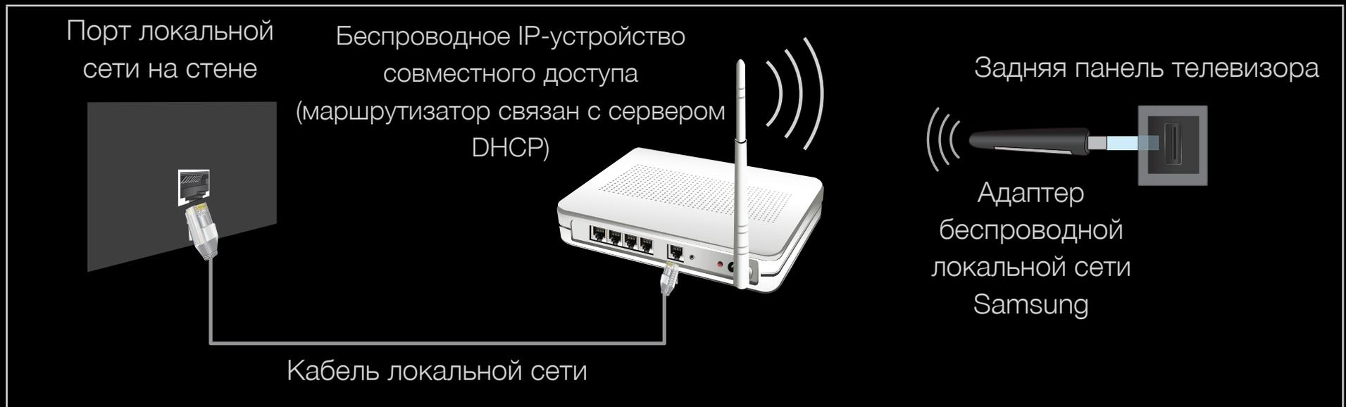
Адаптер беспроводной локальной сети Samsung можно приобрести отдельно в некоторых розничных магазинах, через электронные магазины или на веб-узле Samsungparts.com. Адаптер беспроводной локальной сети Samsung поддерживает протоколы связи IEEE 802.11A/B/G и N. Samsung рекомендует использовать протокол IEEE 802.11N. При воспроизведении видео через соединение IEEE 802.11B/G возможны перерывы.
