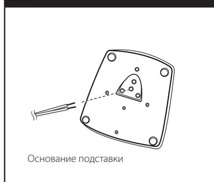
3. Установите AC на клеммную колодку и закрепите его с помощью винта, поставляемого в комплекте.
