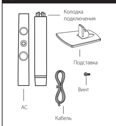
1. Установите колодку на подставку и закрепите ее с помощью винта, поставляемого в комплекте.
