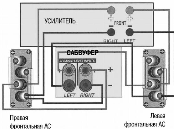
**Если ваши АС подключены по двухпроводной схеме:** Проследите за тем, чтобы сабвуфер был подключен ТОЛЬКО к клеммам НИЗКИХ ЧАСТОТ.
