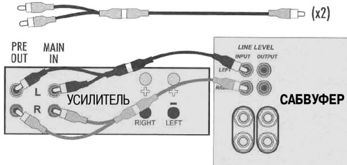
**B:** Вам понадобятся два стереофонических (или четыре одножильных) экранированных кабеля формата RCA. Стереофоническим кабелем соедините разъемы «Input» [Вход] из группы «Line Level» [Линейный уровень] на сабвуфере с разъемами усилителя «Pre Out» [Выход предусилителя]. Вторым стереофоническим кабелем соедините разъемы «Output» [Выход] из группы «Line Level» на сабвуфере с разъемами усилителя «Main In» [Вход усилителя мощности]. Сабвуфер теперь встроен в контур системы.
