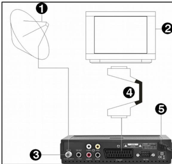
Затем подключите кабель от конвертера на антенне (1) к коннектору SAT IN (3) приемника. Используйте кабель SCART (4) для подключения к ТВ (2). По завершению процедуры подключите кабель питания (5) к сети.
