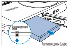
Отведите фиксатор вниз, чтобы извлечь аккумуляторную батарею.
