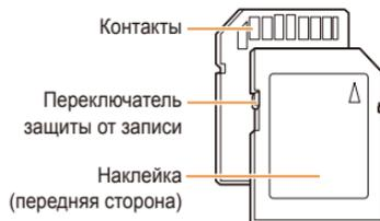
С помощью переключателя защиты от записи на карте SD или SDHC можно запретить удаление файлов. Переместите переключатель вниз, чтобы установить защиту, или вверх, чтобы снять ее. Во время съемки защита должна быть отключена
