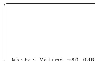
Экран отображения состояния: Текущее состояние временно отображается на экране при переключении источника входного сигнала или изменении уровня громкости.
