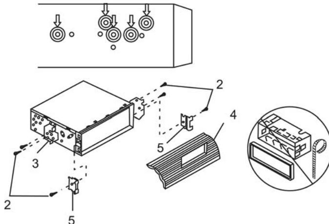
1. Выберите положение кронштейнов, при котором будут совмещены резьбовые отверстия на кронштейнах и резьбовые соединения на корпусе устройства. Закрепите кронштейны с обеих сторон устройства не менее чем в двух местах. Для этого используйте либо крепежные винты (5 x 6 мм), либо винты с потайной головкой (4 x 6 мм), в зависимости от типа резьбовых отверстий на кронштейне.
