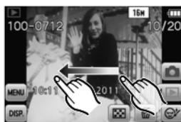
Используется для просмотра следующего/предыдущего изображения путем перетаскивания по горизонтали или изменения диапазона отображаемого изображения. Может также использоваться для переключения страниц при помощи ползунка.
