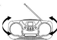
Для приема радиостанций диапазона AM устройство оснащено встроенной магнитной антенной. Для оптимального приема требуется поворачивать по горизонтали корпус самого аппарата.
