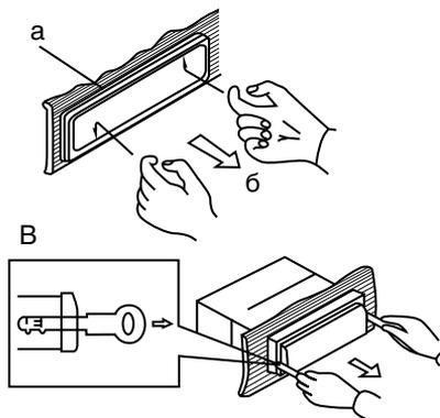
1. Выключите магнитолу и снимите переднюю панель.
