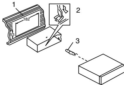
1. Установите монтажный кожух в приборную панель автомобиля, убедитесь, что он установлен правильной стороной и нет препятствий (провода, элементы приборной панели) для установки магнитолы.
