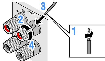
**1** Удалите приблизительно по 10 мм изоляции на концах кабелей колонки и надежно скрутите оголенные провода кабелей во избежание короткого замыкания.
