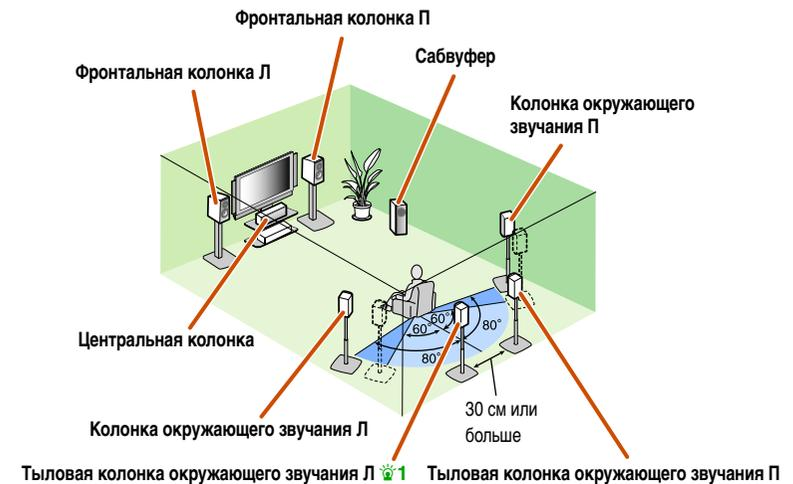
С помощью данной конфигурации колонок можно без ухудшения качества воспроизводить аудиосигнал от 7.1-канального источника аудиосигнала.
