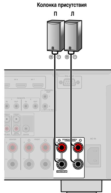
К данному аппарату можно подключить колонки присутствия (PL/PR), используемые для вывода фронтальных звуковых эффектов. С помощью звуковых программ (с. 57) можно создавать звук с эффектом присутствия в более богатом и просторном помещении.
