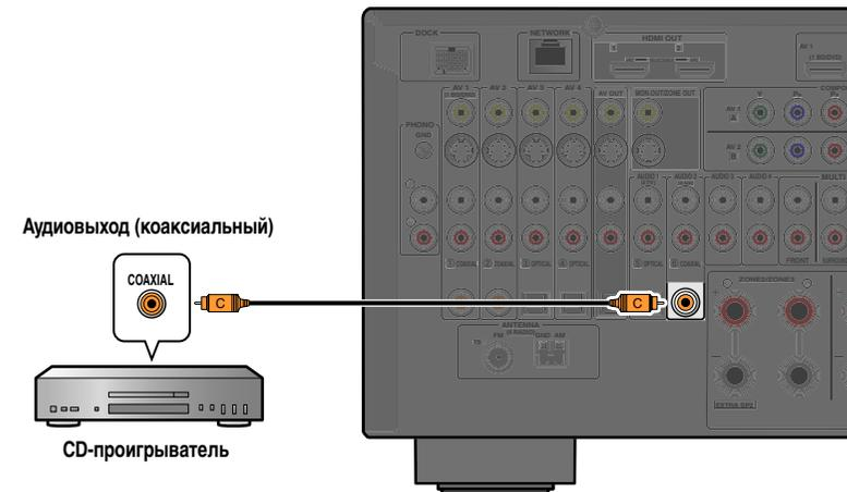
Рекомендуется подключать аудиоустройства с коаксиальным цифровым выходом к коаксиальному цифровому гнезду AUDIO2 на данном аппарате. Данное подключение позволяет переключаться на вход AUDIO2 простым нажатием клавиши "CD" SCENE [\(стр.с. 49\)](#).
