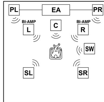
При одновременном использовании фронтальных колонок, поддерживающих двухканальное усиление, и фронтальных колонок присутствия, можно получить более богатое звуковое поле.
