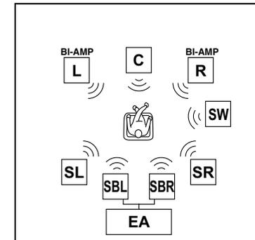
Подключение тыловых колонок окружающего звучания к внешнему усилителю позволяет одновременно использовать фронтальные колонки, поддерживающие двухканальное усиление, и тыловые колонки окружающего звучания.
