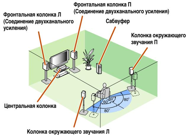
Использование фронтальных колонок, поддерживающих соединения двухканального усиления, позволяет получить высококачественный звук.
