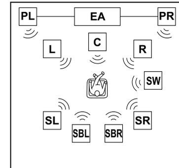
Каналы фронтальных колонок присутствия и тыловых колонок окружающего звучания могут выводиться одновременно.
