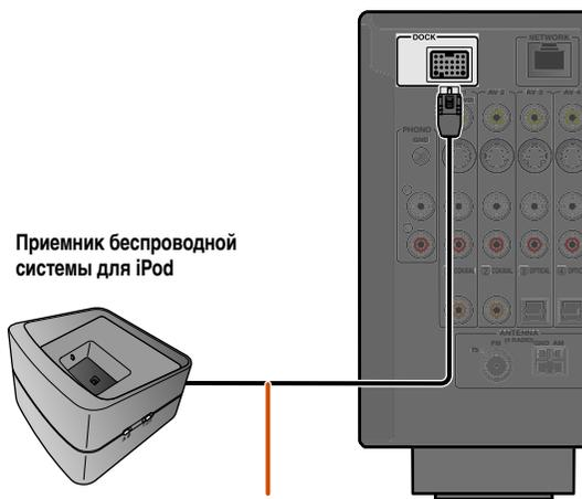
Приемник беспроводной системы для iPod
