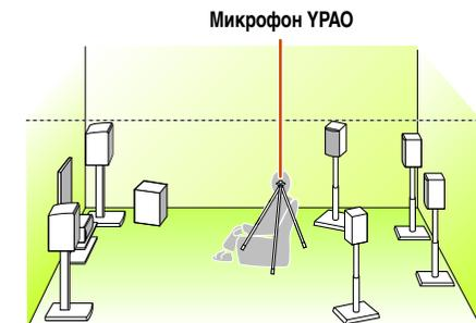
Во время установки микрофона рекомендуется использовать в качестве подставки для микрофона оборудование, позволяющее регулировать его высоту (например, штатив). При использовании штатива воспользуйтесь винтами штатива для закрепления микрофона на месте.
