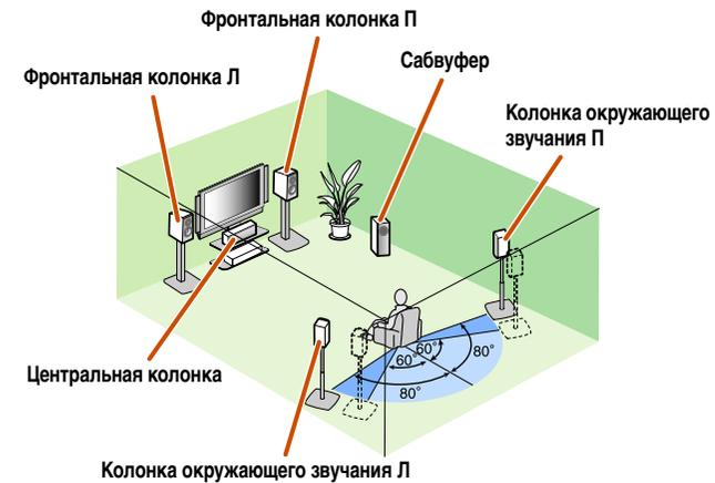
Данный аппарат позволяет уменьшать количество каналов 7.1-канального источника аудиосигнала для получения 5.1-канального звука. Это позволяет выводить 7.1-канальный звук без использования тыловых колонок окружающего звучания.
