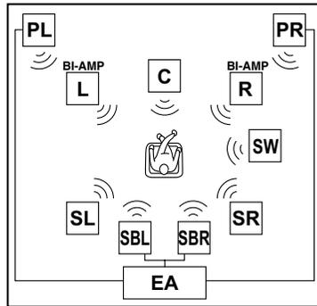
При использовании внешнего усилителя можно использовать фронтальные колонки присутствия и тыловые колонки окружающего звучания одновременно с фронтальными колонками, поддерживающими двухканальное усиление. 🗨️1
