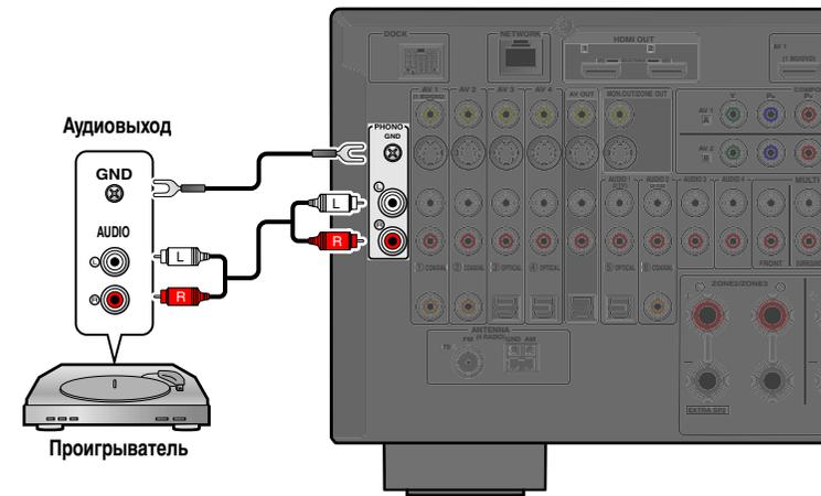
Для уменьшения шумов в сигнале подключите проигрыватель к разъему GND данного аппарата.
