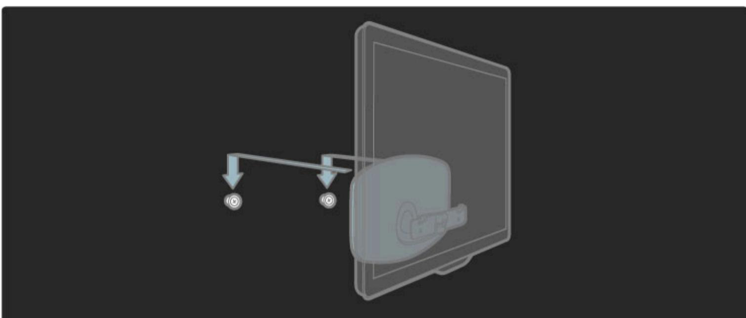
Чтобы выровнять телевизор, слегка потяните за его нижнюю часть на себя и отрегулируйте положение с помощью дисков.
