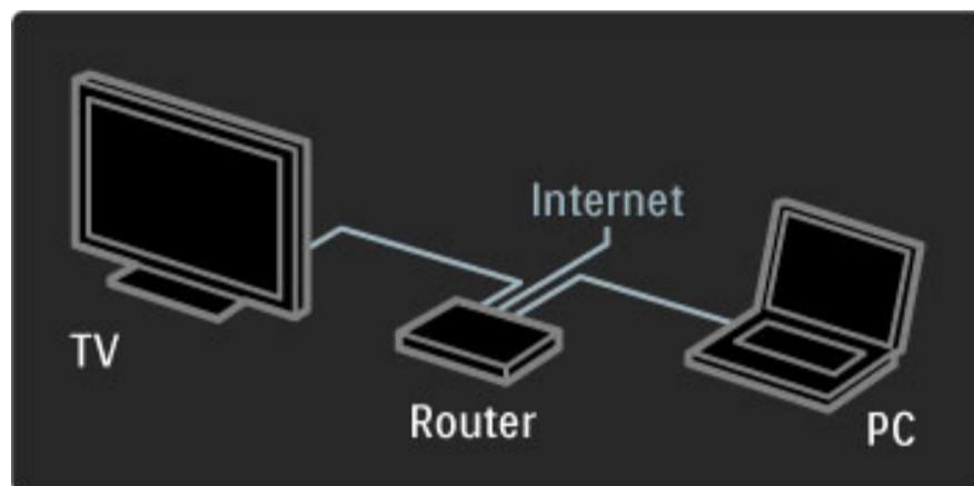
Для проводного подключения к маршрутизатору требуется сетевой кабель (Ethernet).
