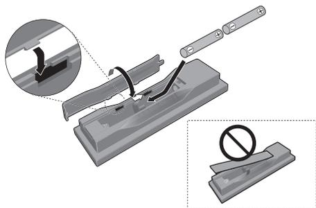
Для закрытия задней крышки, выровняйте защелку с канавкой и задвиньте ее в направлении, указанном стрелкой (⇒).
