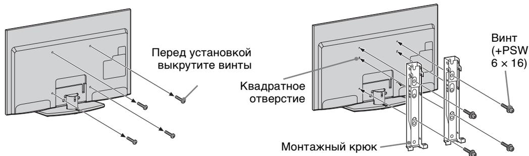
Для правильной установки данного изделия необходим достаточный опыт, в особенности при определении того, в состоянии ли стена выдержать вес телевизора. Обязательно привлеките для установки этого изделия на стену дилеров или лицензированных подрядчиков Sony и строго соблюдайте технику безопасности при выполнении работ по установке. Компания Sony не несет ответственность за любые поломки или травмы, вызванные неправильным обращением с изделием или его неправильной установкой.
