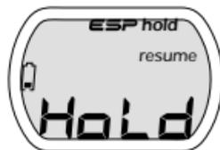
2 Для того, чтобы отключить функцию HOLD, установите переключатель в положение OFF.
