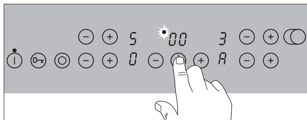
2. Пока контрольная лампочка работает в режиме быстрого мигания, сенсорными полями “Установка таймера”  $\oplus$  или  $\ominus$  задайте для этой зоны нагрева нужное время до автоматического отключения (например, 15 минут).
