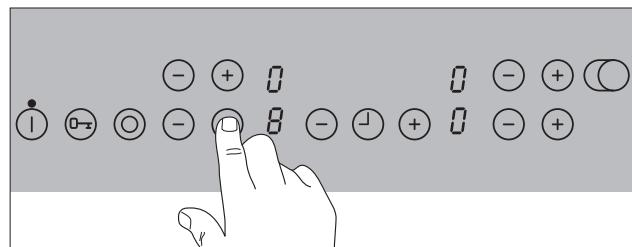
**i** Если во время действия автоматического режима вы выберете более высокую ступень нагрева, например перейдете с ② на ③, то соответственно изменится и время быстрого закипания. Если же Вы выберете более низкую ступень нагрева, режим быстрого закипания сразу перестанет действовать.
