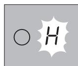
После отключения конфорок индикация остаточного нагрева отключается только после того, как конфорка остывла.
