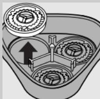
**3** Поверните колесико против часовой стрелки (1) и снимите фиксирующую рамку (2).
