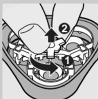
**2** Нажмите кнопку защелки (1) и снимите бритвенный блок (2).
