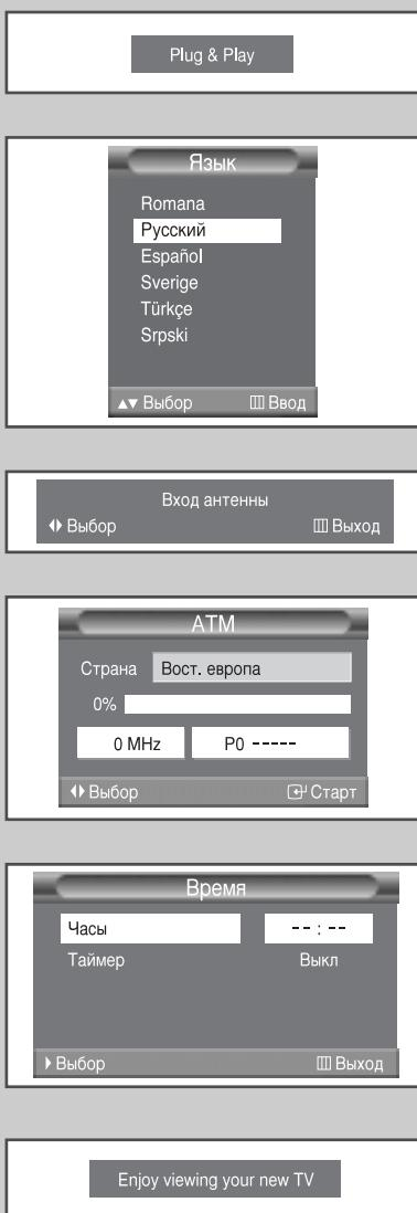
*При первом включении телевизора, автоматически, одна за другой, будут выведены три основные настройки для пользователя: установка языка, канала и текущего времени.*
