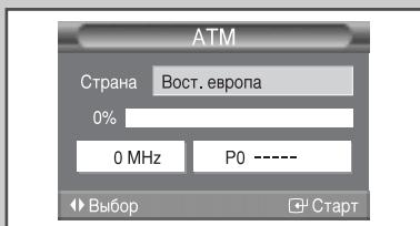
*Можно произвести сканирование доступных частотных диапазонов (диапазоны частот зависят от страны, в которой вы находитесь). Автоматически распределенные номера программ могут не соответствовать фактическим или желаемым номерам программ. Тем не менее, можно отсортировать номера вручную и удалить нежелательные каналы.*
