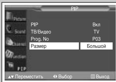
*В пределах основного изображения телевизионной программы или внешнего устройства, такого как видеомагнитофон или DVD-проигрыватель, можно отображать дополнительное изображение. Таким образом, можно смотреть телевизионную программу или изображение, сигнал которого поступает с видеовхода, одновременно с другой телепрограммой или изображением, сигнал которого поступает с другого видеовхода.*
