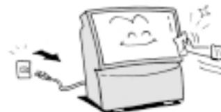
**Если на соединениях электрической вилки скопилась пыль, выдерните вилку из розетки и сотрите пыль.**
