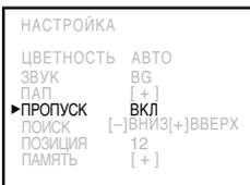
**5** Нажмите кнопку **CALL** (ВЫЗОВ) для выключения дисплея меню. Выберите номер канала, который должен быть пропущен с помощью **Цифровых** кнопок. Слева от номера канала появляется символ "\*\*\*". Данный номер программы будет теперь пропущен при выборе Вами канала с помощью кнопок **СН** (КАНАЛ) ▲▼.
