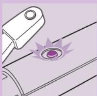
**1** После закрепления насадки на приборе установите прибор для укладки волос на опору и вставьте вилку шнура питания в розетку электросети. Загорится индикатор питания, и прибор начнет нагреваться.
