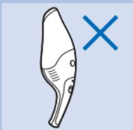
**4** Не устанавливайте пылесос в положение пылесборником вверх, так как это может привести к проникновению жидкости в электроприбор и порче внутренних деталей.
