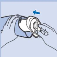
**6** Установите фильтр и дефлектор на место в отсек пылесборника.
