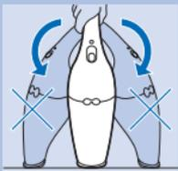
**3** При сборе жидкостей удерживайте пылесос в таком положении, чтобы отсек пылесборника был ориентирован вниз под углом. Убедитесь в том, что резиновый скребок касается очищаемой поверхности. Не наклоняйте электроприбор в сторону.
