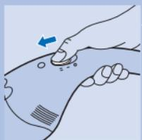
**2** Для работы с нормальной силой всасывания установите переключатель в положение «I». Установите переключатель в положение «II» для повышения силы всасывания.
