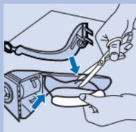
**2** Последовательно обрежьте соединительные провода, а затем выньте аккумуляторную батарею.
