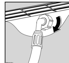
Другой конец наливного шланга, подключающийся к машине, может быть повернут в любом направлении. Ослабьте гайку, поверните шланг и вновь затяните гайку, проверив отсутствие течей воды. Наливной шланг нельзя вытягивать. Если он слишком
