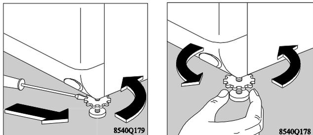
Аппарат выравнивается с помощью ввинчивания или вывинчивания винтовых установочных ножек. Точная установка позволяет избежать вибраций, шума и перемещения машины во время работы. После выравнивания следует заблокировать ножки, затянув стопорные кольца вручную или с помощью отвертки.
