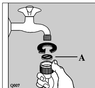
Навинтите соединительное кольцо шланга на резьбовой конец водопроводного крана (20 x 2,7), не забудьте установить прокладку А (поставляется вместе с прибором). Подводной
