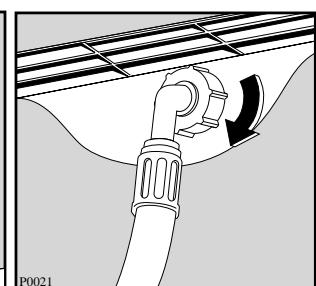
Другой конец наливного шланга, подключающийся к машине, может быть повернут в любом направлении. Ослабьте гайку, поверните шланг и вновь затяните гайку, проверив отсутствие течей воды.
