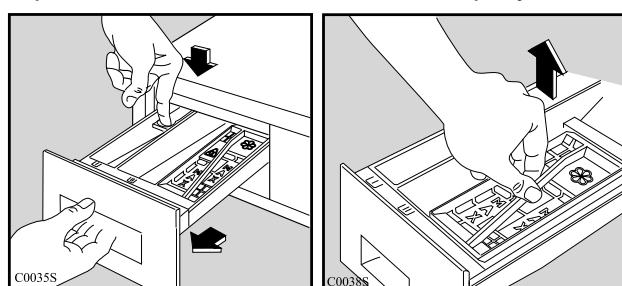
Стиральный порошок скапливается и в углублении дозатора. Для чистки углубления можно использовать старую зубную щетку.
