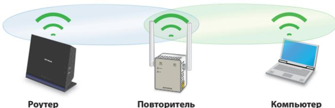
19. Проверьте расширенную зону покрытия WiFi, переместив компьютер или WiFi-устройство в область со слабым сигналом роутера WiFi:
