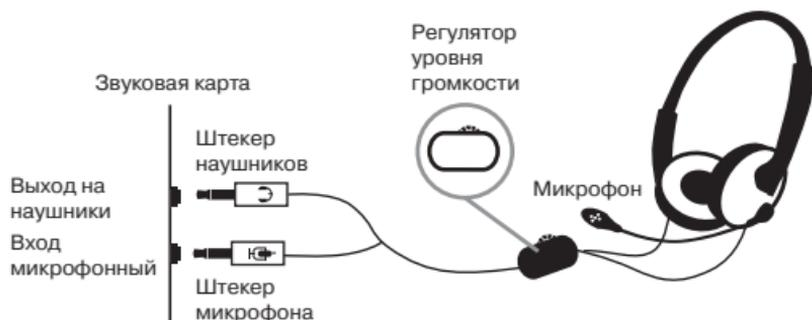
Рис. 1. Схема подключения
