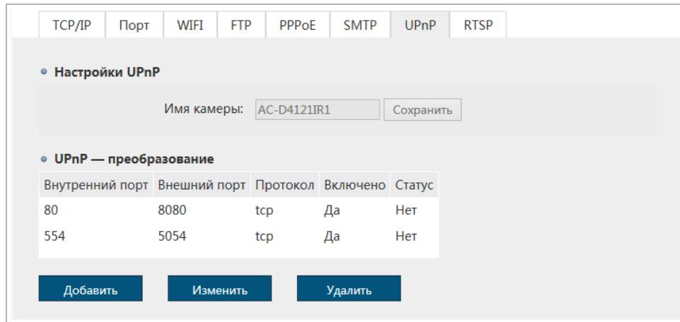
Функция **Universal Plug&Play(UPnP)** используется для поиска IP-камеры в локальной сети интеллектуальными системами видеонаблюдения. В блоке **Настройки UPnP [UPnP Settings]** в поле **Имя камеры [Camera name]** введите имя, которое будет отображаться при поиске данного устройства.
